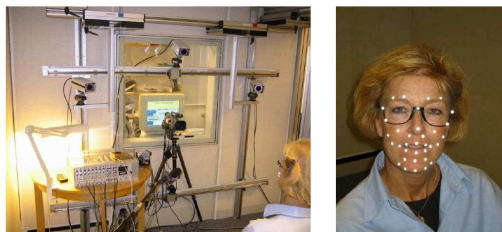
Obrázek 3.4: Ukázka systému optického trasování. V tomto případě je použit Qualisys systém a 4 kamery. Vpravo pak můžeme vidět 28 značek na tváři řečníka.
