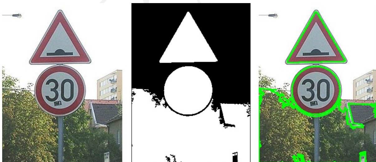
Obrázek 13: Ukázka detekce MSERů v obraze. Vstupní obraz (vlevo), prahovaný obraz jako mezikrok MSER detekce (uprostřed) a vykreslené hranice nalezených MSERů (vpravo).
